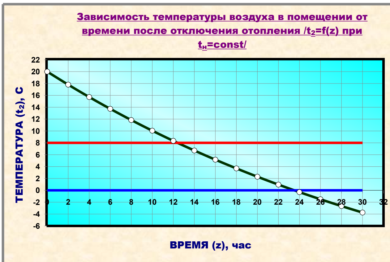
Рисунок 11.2.1 – Зависимость температуры воздуха в помещении от времени после отключения отопления при наружной t_{\text{наруж.}} = -10^{\circ}\text{C}
